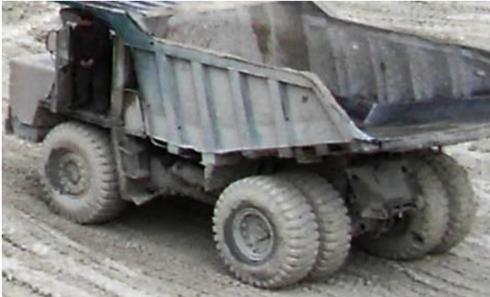
Рис.17. . Фото зносу шин у центральній частині бігової доріжки, вириви та пошкодження бокової частини шин задніх коліс.
