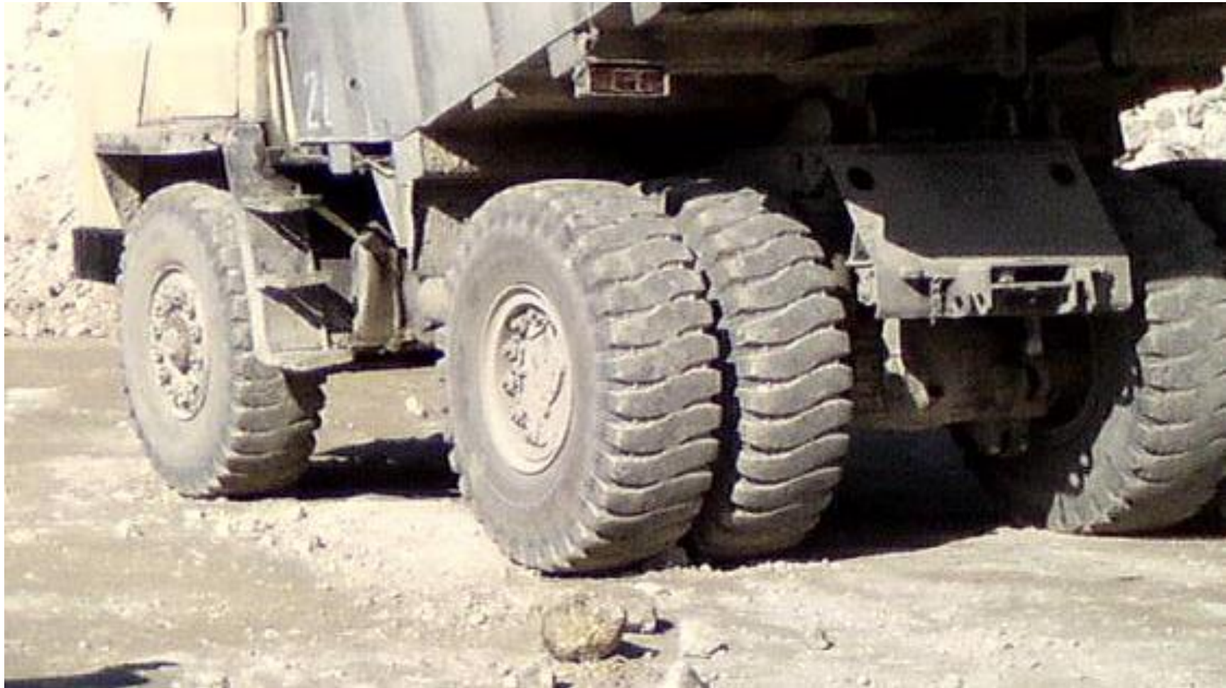
Рис.18. . Фото зносу шин у центральній частині бігової доріжки переднього лівого та задніх лівого зовнішнього та правого внутрішнього.
