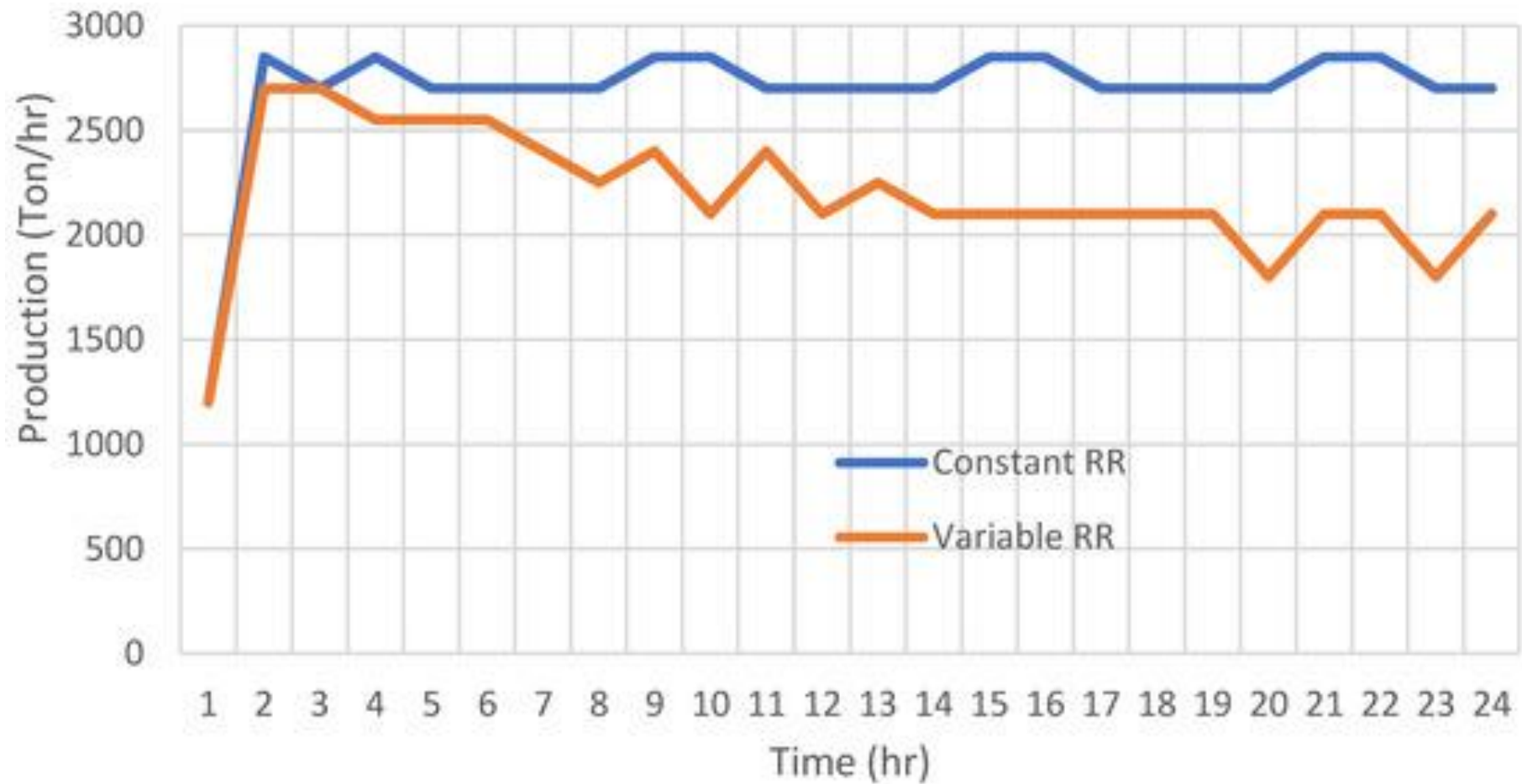
Рисунок 7. Виробництво, виражене в тоннах/год між моделлю, яка не враховує RR дороги з часом (постійний RR), моделлю, яка враховує це явище (змінна RR).
