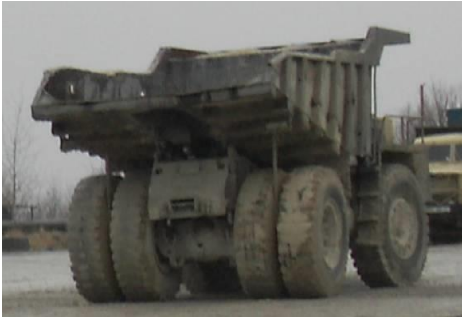
Рис.16. Фото зносу шин у центральній частині бігової доріжки задніх лівих коліс.
