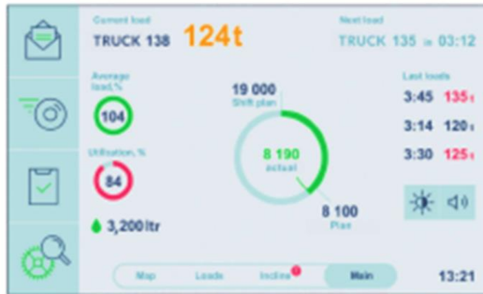
Рис.2.2. Екран оператора кар'єрного самоскида із системою контролю завантаження та витрати палива
