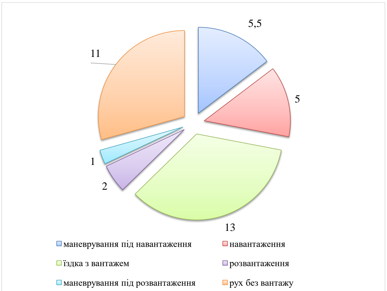
Рис.2.8. Структура транспортного циклу кар'єрного самоскида, хв.
