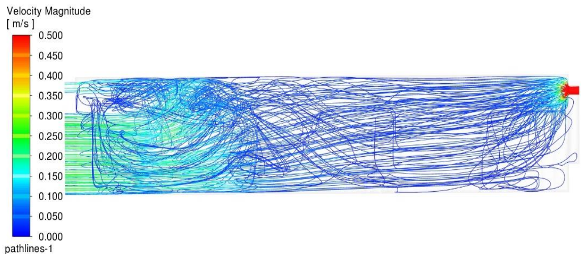
Рис. 3.16 - Напрямок і швидкість повітряних потоків в приміщенні торгової зали з вентиляторами і додатковими вентиляційними отворами (вигляд від правої стіни).
