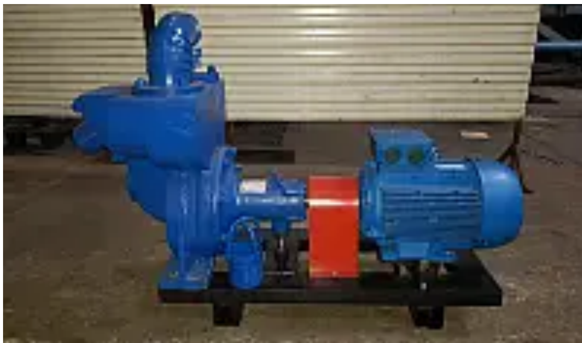
Рисунок 2.3- Водяний насос Андиганец С-245
