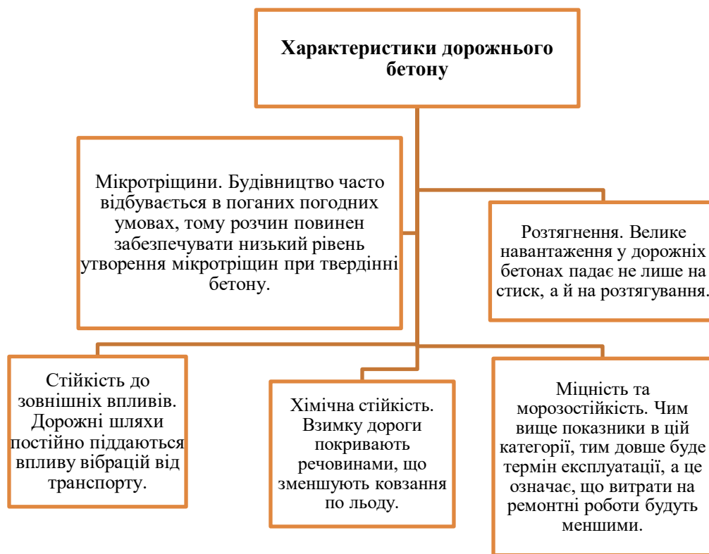
Рисунок 3. Характеристика дорожнього бетону
