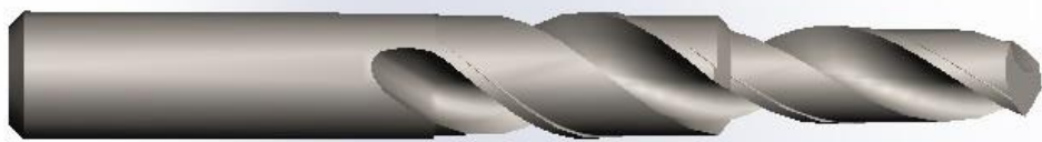
Рисунок 4.2 - 3D-модель комбінованого свердла
