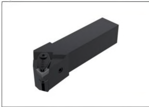
Рисунок 3.1 – Державка DCLCL2525X09JETI [3 с. 206] Геометричні параметри: H=25\text{мм} ; B=25\text{мм} ; LF = 36\text{ мм} ; LH = 38\text{ мм} ; WF = 32\text{ мм}
