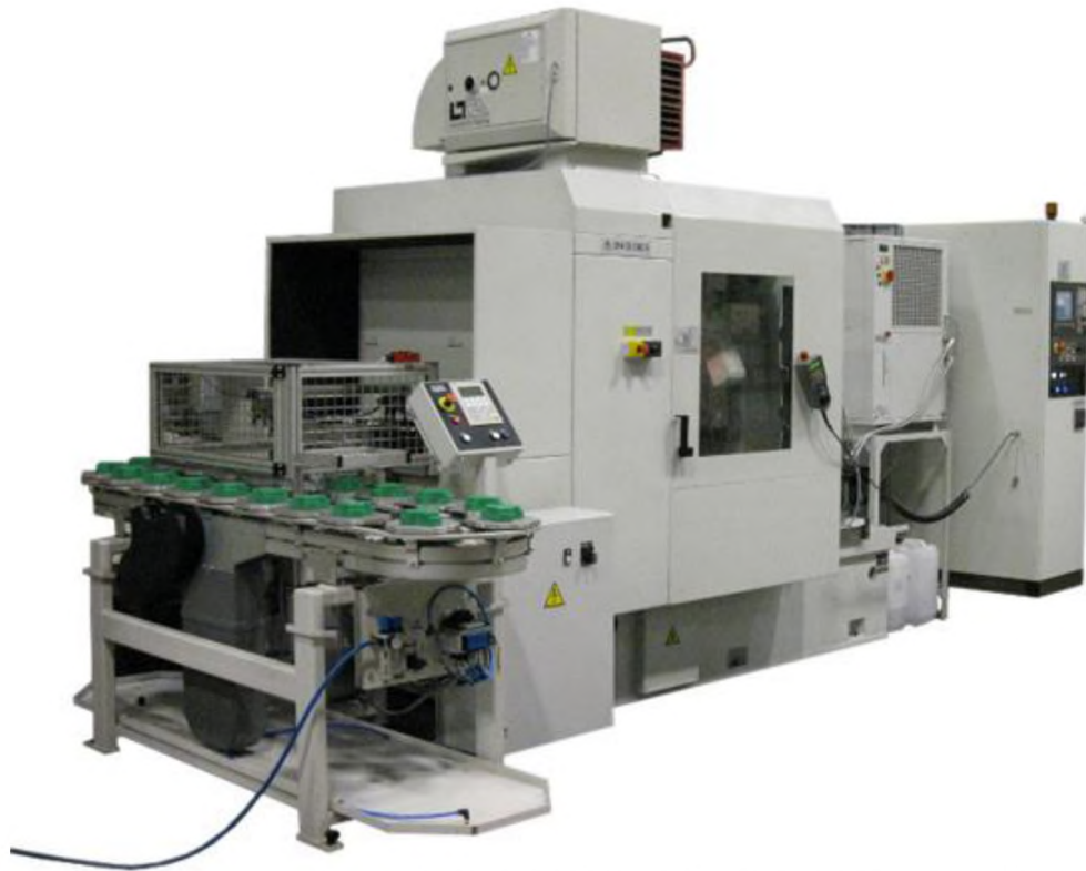
Рисунок 2.3 – Вертикальний зубофрезерний верстат моделі OFA 32 CNC 6
