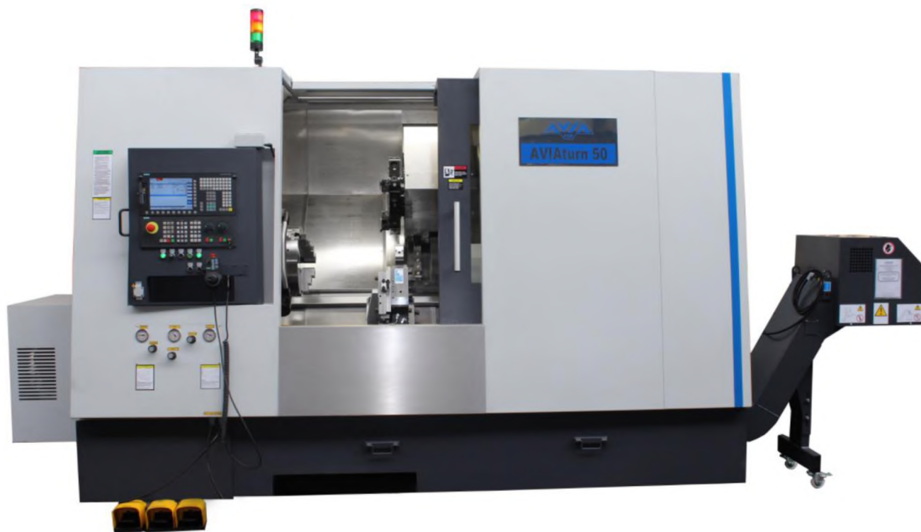
Рисунок 2.2 – Токарний верстат з ЧПК моделі Aviaturn 50
