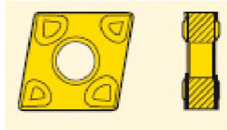
Рисунок 3.14 – Пластина CNMG 120408-FF2, покриття TP1500 [1, с. 196]
