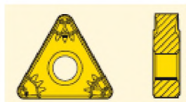
Рисунок 3.22 – Пластина TNMG 160408-MF5, покриття TP1500 [1, с. 220]
