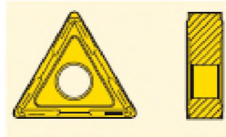
Рисунок 3.26 – Пластина TNMG 160404-MF2, покриття TP1000 [1, с. 219]
