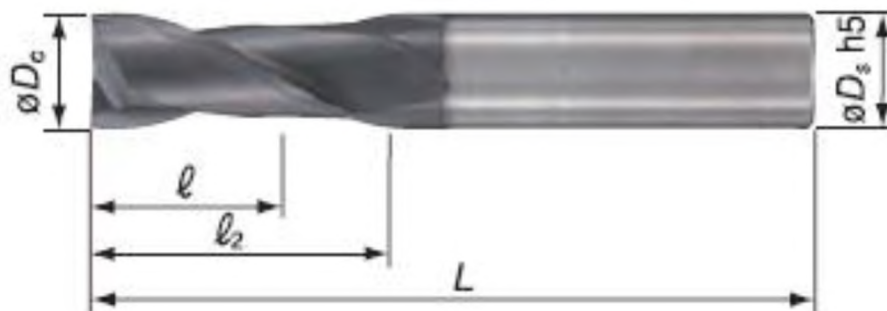
Рисунок 3.8 – Ескіз шпонкової фрези
