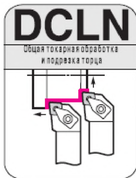
Рисунок 3.1 – Різець для зовнішньої обробки з ромбічною пластиною
