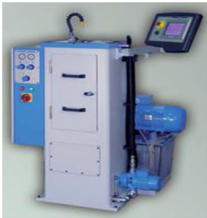
Рисунок 2.4 – Протяжний верстат HNZ 70/650 TA easy Технічні характеристики
