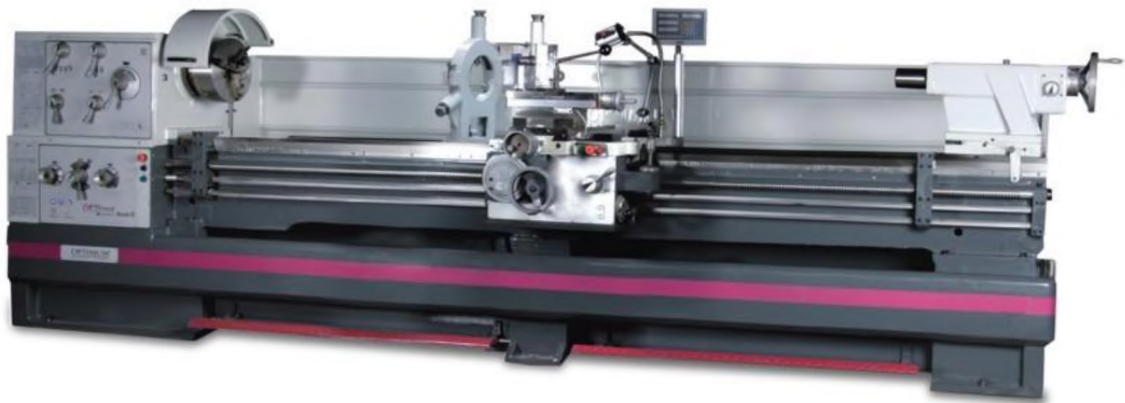
Рисунок 2.2 – Токарно-гвинторізний верстат Opti TU8020
