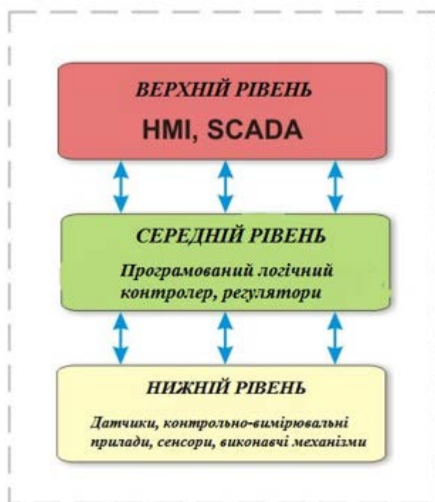
Рисунок 2.36 – Функціональна схема рівнів системи керування стабілізації тиску в магістралі
