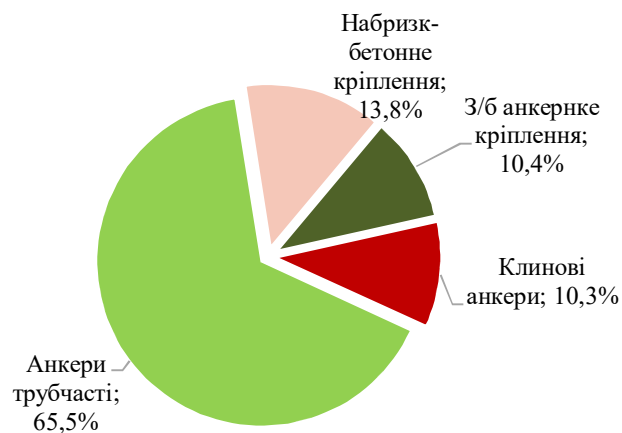
Рисунок 3.11 – Структура неметалевих видів кріплення в АТ «КЗРК»
