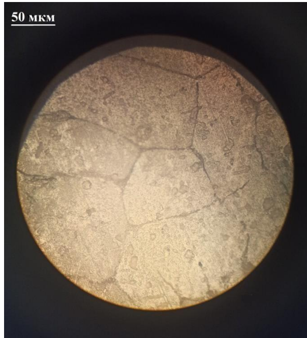
Рисунок 13 - Мікроструктура вихідного алюмінієвого сплаву - АД31
