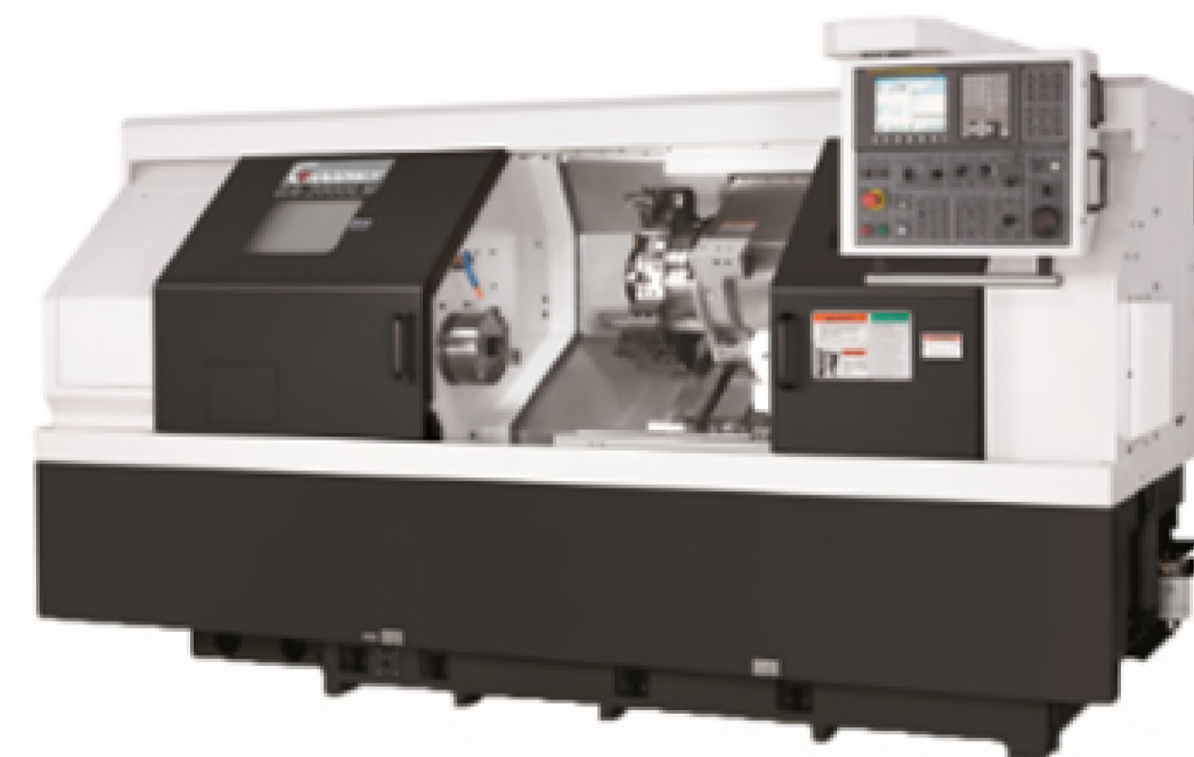
Загальний вид верстата горизонтально токарно-револьверний верстат з ЧПУ моделі GA-2000
