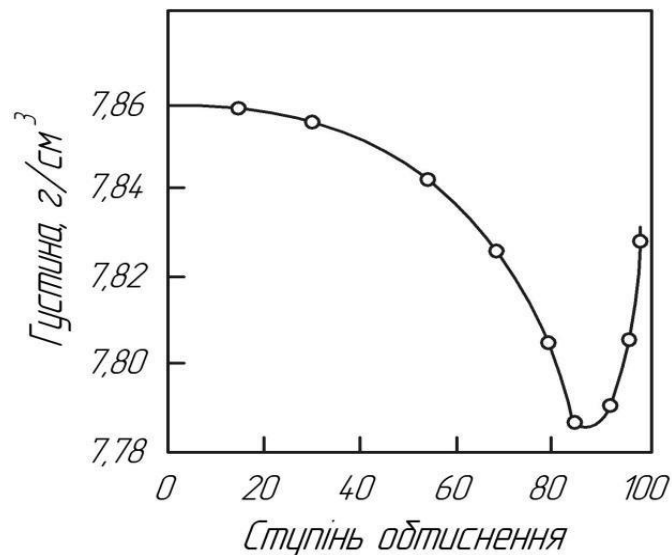
Рисунок 1.3 – Вплив ступеню обтиснення на густину сталевих матеріалів
