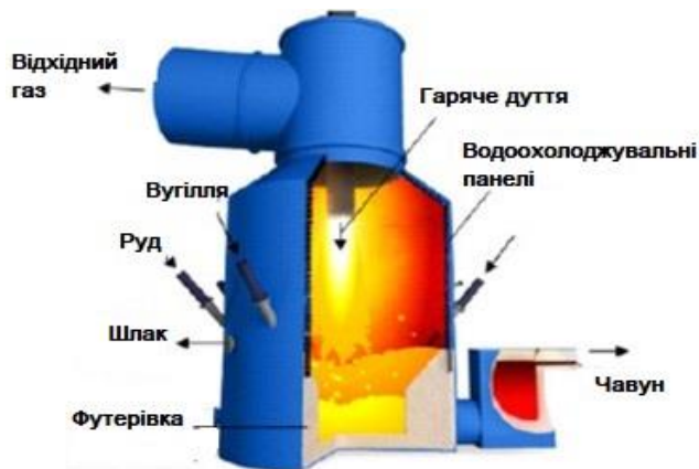
Рисунок 17 - Схематичний розріз плавильно-відновлювального агрегату Hismelt.
