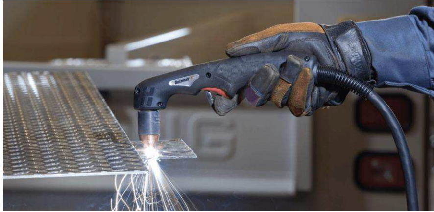
Малюнок 7 - Плазмовий різак
