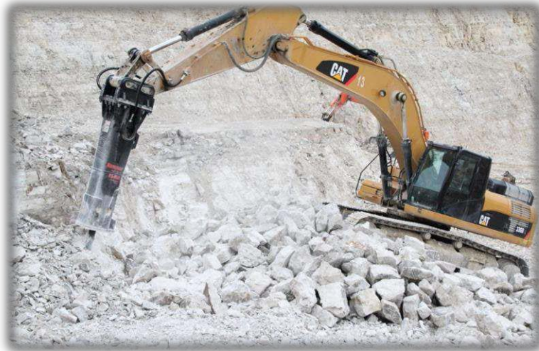
Малюнок 1 – Гідромолот для екскаватора
