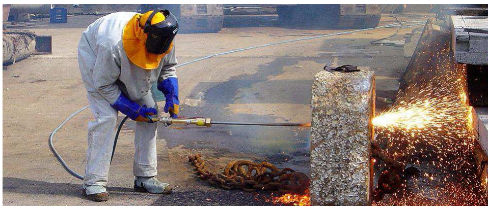
Малюнок 5 - Різання з використанням кисневого списи
