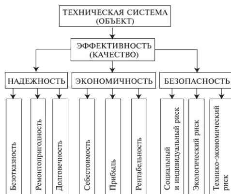
Рис. 1. Основные свойства технических систем
