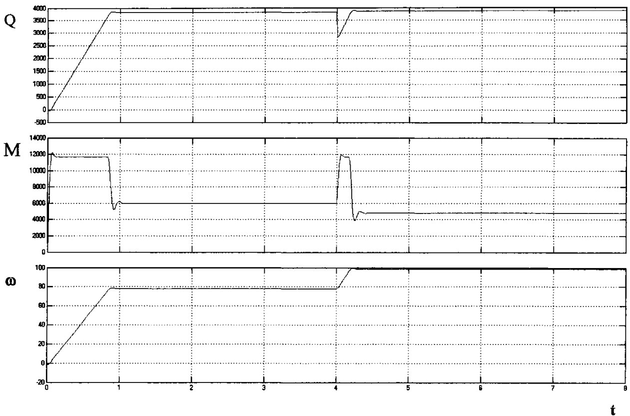
Рис 6.3- Перехідні процеси замкненої САК ЕП по технологічному параметру.
