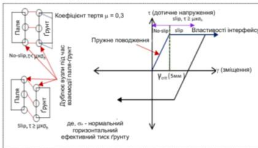
Рисунок 10 – Робота контактного елемента між ґрунтом і стіною в ґрунті
