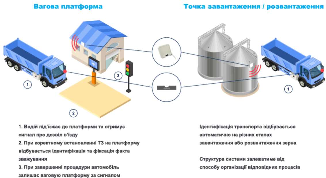
Рисунок 1.3 – Автоматизоване зважування автомобіля за допомогою RFID системи
