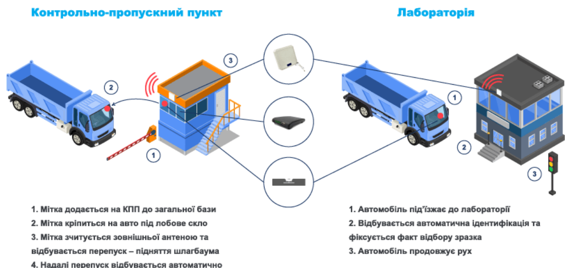
Рисунок 1.2 – Приклад ідентифікації автомобіля за допомогою RFID системи.
