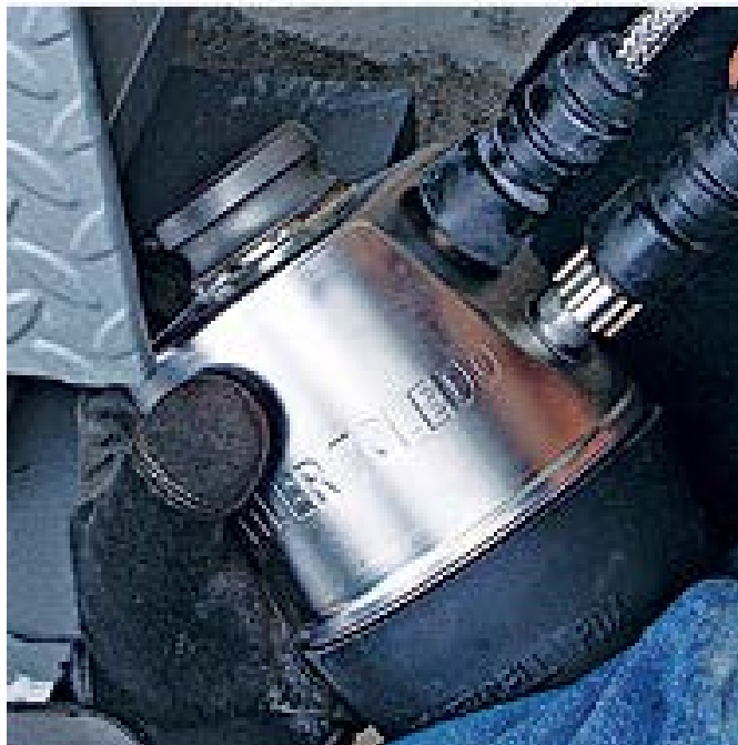
Рисунок 2.3 – Тензометричний датчик МТХ 45t.
