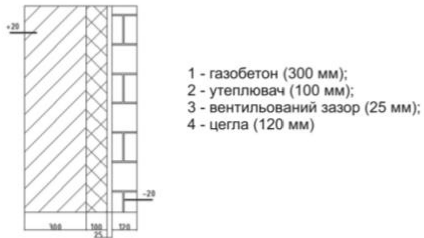
Рисунок 8 – Чотиришаровий варіант стіни
