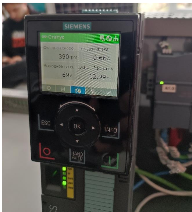
Рисунок 2.4 – частотний перетворювач Sinamics G120 з інтелектуальною панеллю оператора IOP-2
