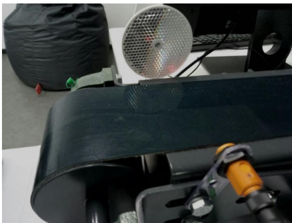
Рисунок 2.7 – Оптичний датчик E3F-DS30C4 з відбивачем
