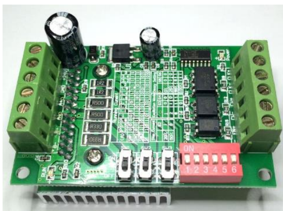
Рисунок 2.5 – Драйвер крокового двигуна ТВ6560 V2
