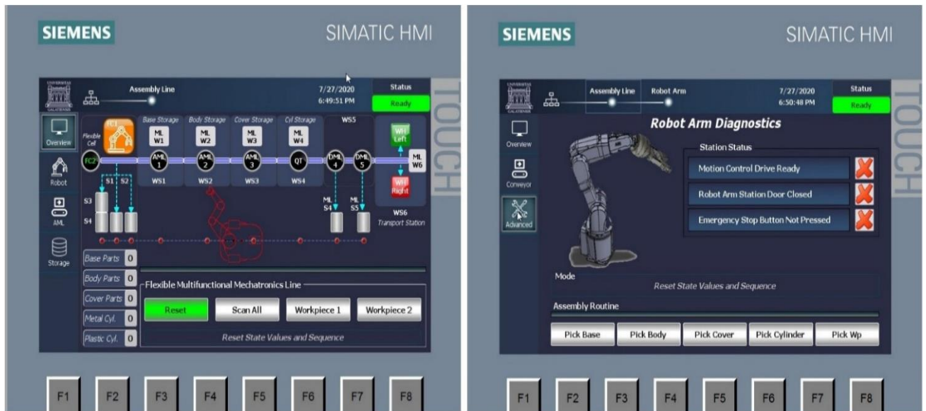
Рисунок 1.2 – Приклад НМІ панелі Siemens WinCC
