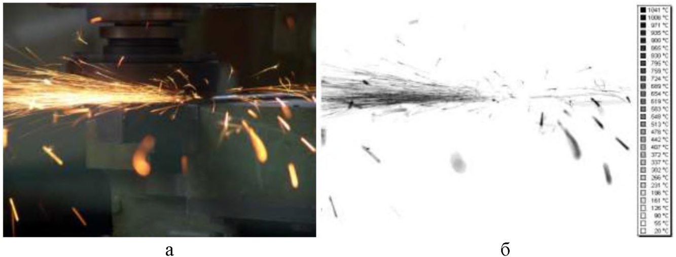
Рисунок 7.2 – Процес високошвидкісної обробки титанового сплаву ВТ3 (а) та тепловий знімок (б): V = 370 м/хв, S = 0,05 мм/зуб, t = 1,1 мм
