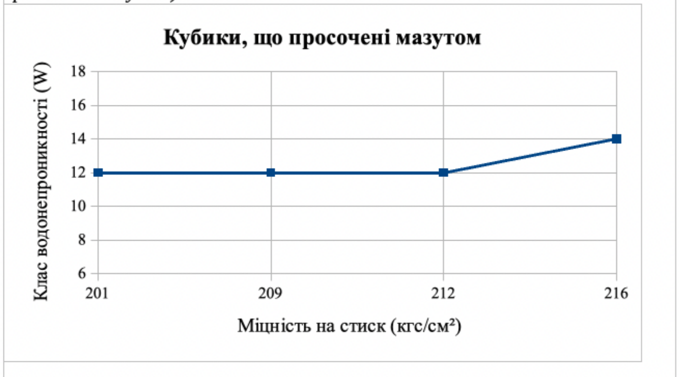
Рис.3. Відношення водонепроникності до міцності бетону (кубики, що просоченні мазутом)
