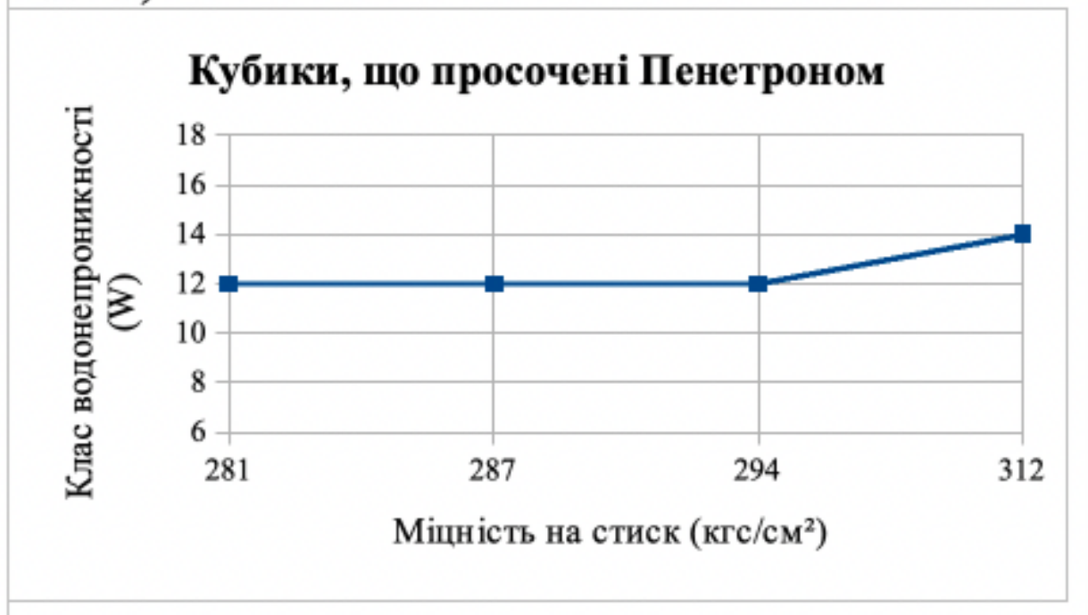
Рис.1. Відношення водонепроникності до міцності бетону (кубики звичайні)
