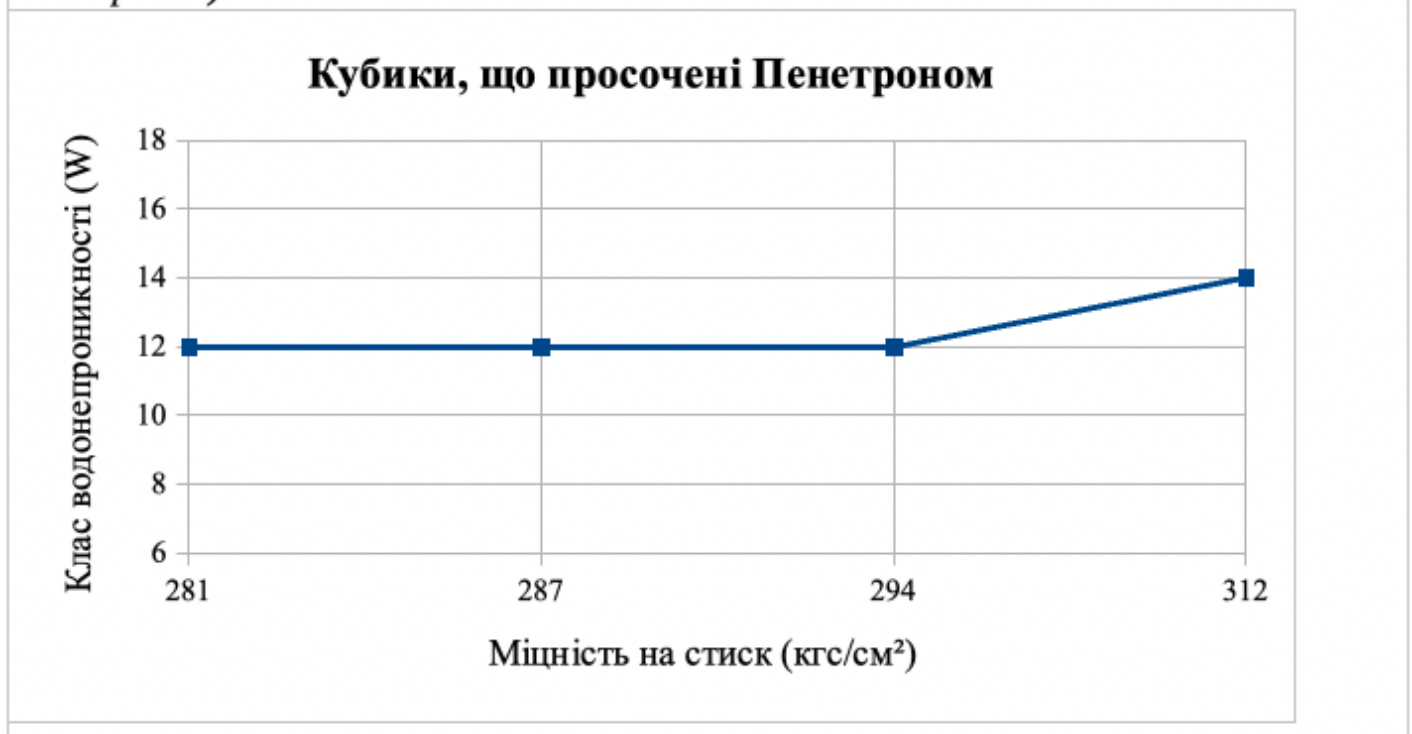
Рис.2. Відношення водонепроникності до міцності бетону (кубики, що просоченні Пенетроном)
