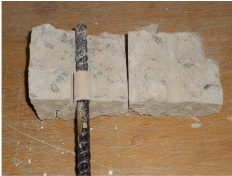
Рис. 5. Руйнування зразка від розколювання бетону при випробуванні на висмикування
