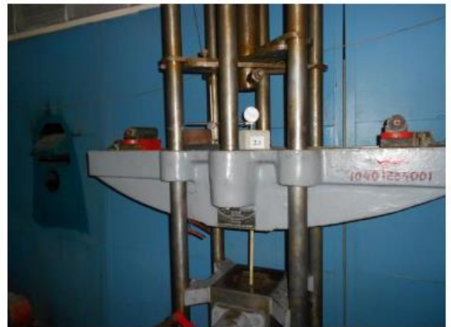
Рис. 4. Загальний вид випробувань АКП на висмикування
