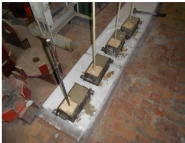
Рис. 3. Виготовлення зразків для випробувань на висмикування
