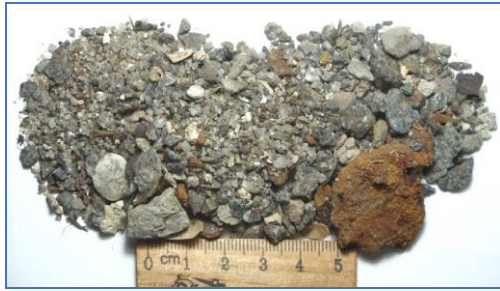
Рис. 3.11. Пісок крупнозернистий з гранітним відтінком і включеннями гідроксиду заліза. Зразок С-7-20.
