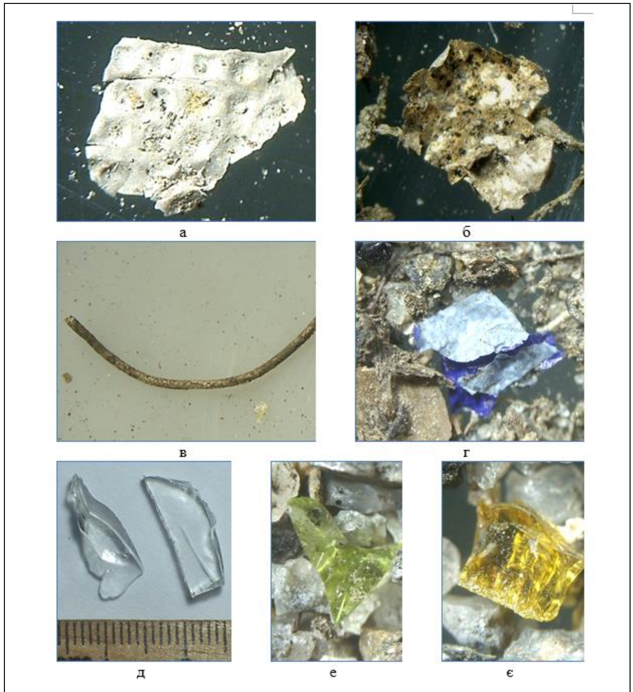
Рис. 3.14. Промислові компоненти алювію: а, б – Al фольга; в – окремий фрагмент виробу з срібла; г – пластик; д – є – уламки побутового скла. Бінокулярний мікроскоп, збільшення: а, б – 30^{\times} ; в – 5^{\times} ; г - є – 10^{\times} .
