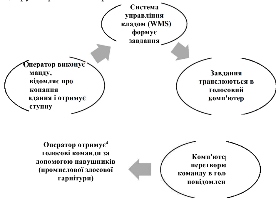
Рис. 3.4. Процес голосового відбору (або «Pick by Voice»)
