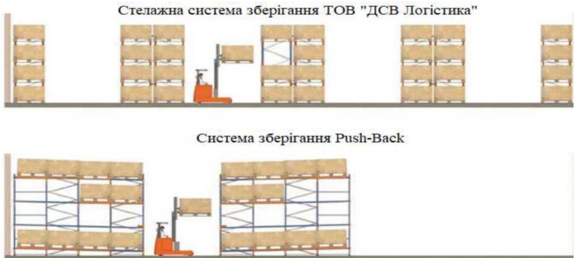
Рисунок 3.1. – Стелажне зберігання на ТОВ «ДСВ Логістика» та запропонована «Push-Back»
