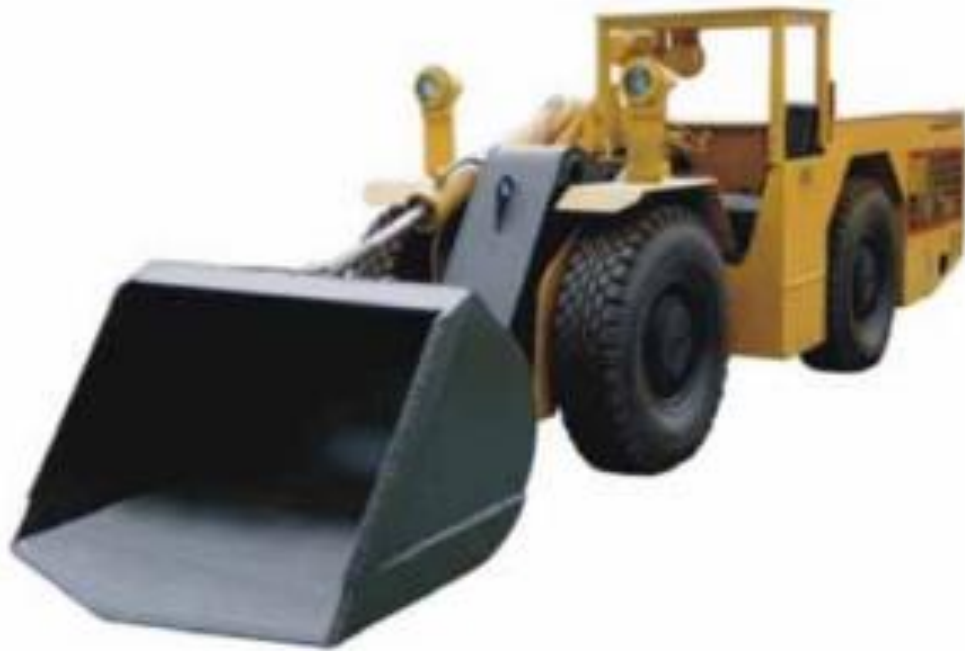
Рисунок 3.4 – Загальний вигляд НТМ ПД-2Е
