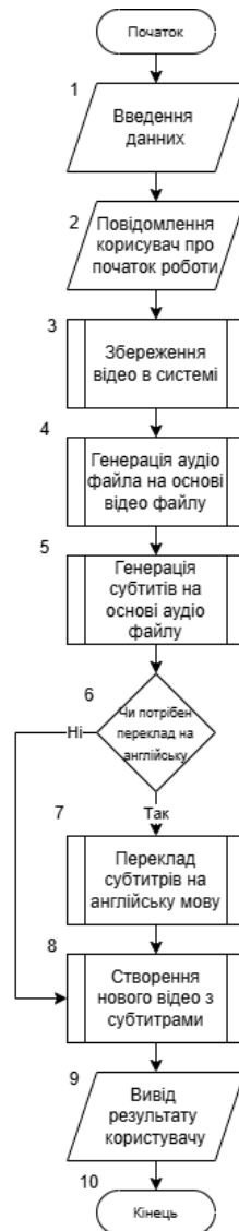
Рисунок 2.4 — Блок-схема алгоритму автоматичної генерації субтитрів
