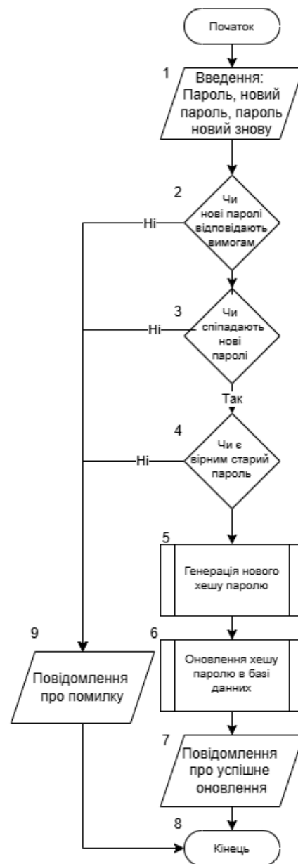
Рисунок 2.3 — Блок-схема алгоритму оновлення паролю
