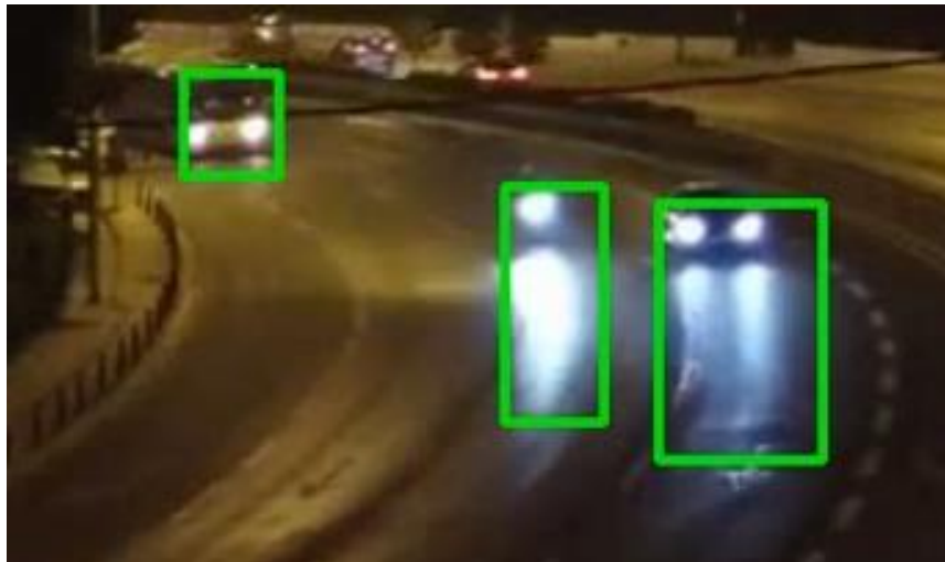
Рисунок 4.2 – Демонстрація вразливості алгоритму на основі віднімання фону до умов поганого освітлення
