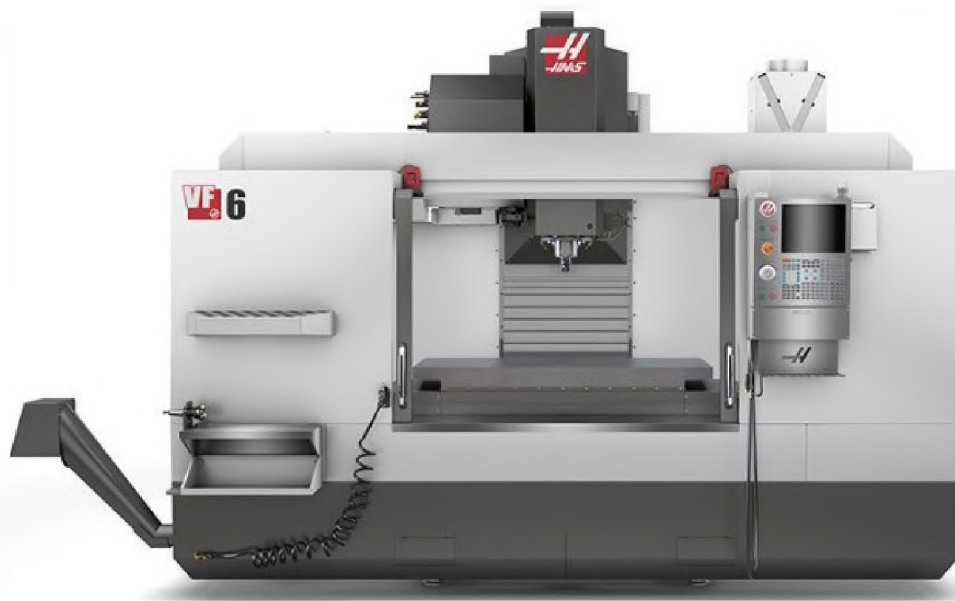
Рисунок 3.11- вертикально-фрезерний обробляючий верстат моделі HAAS VF-6TR
