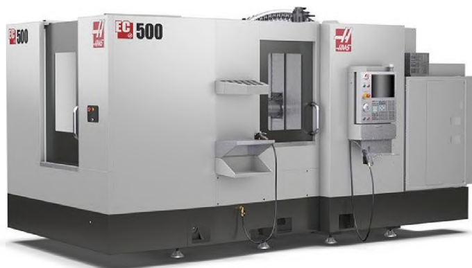
Рисунок 3.12 - Багатоцільовий обробляючий верстат з ЧПК марки HAAS EC-500/50
