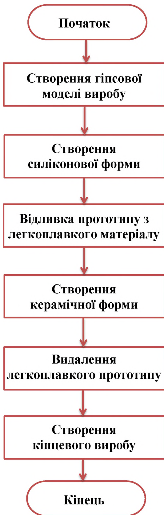
Рисунок 7.1 – Алгоритм процесу лиття по виплавленим моделям
