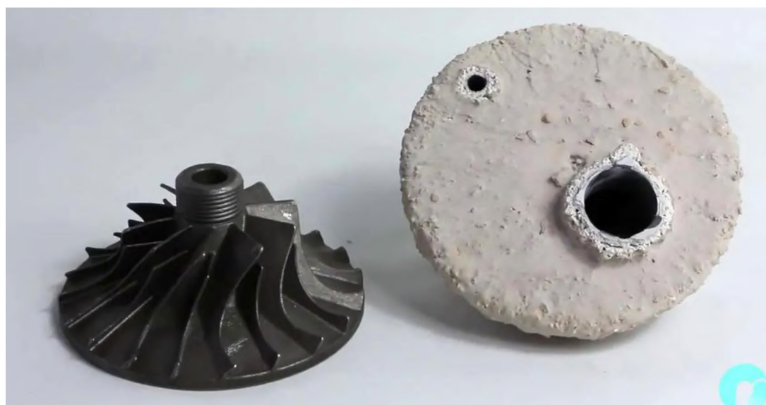
Рисунок 7.4 – Приклад деталі виготовленої литтям по виплавленим моделям, що отримані 3D друком методом FDM
