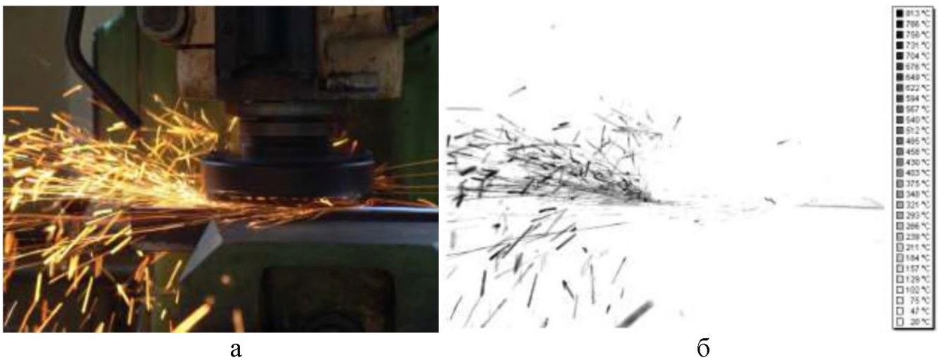
Рисунок 7.3 – Процес високошвидкісної обробки загартованої сталі 45 твердістю 52HRC (а) та тепловий знімок (б): V = 448 м/хв, S = 0,05 мм/зуб, t = 1,2 мм
