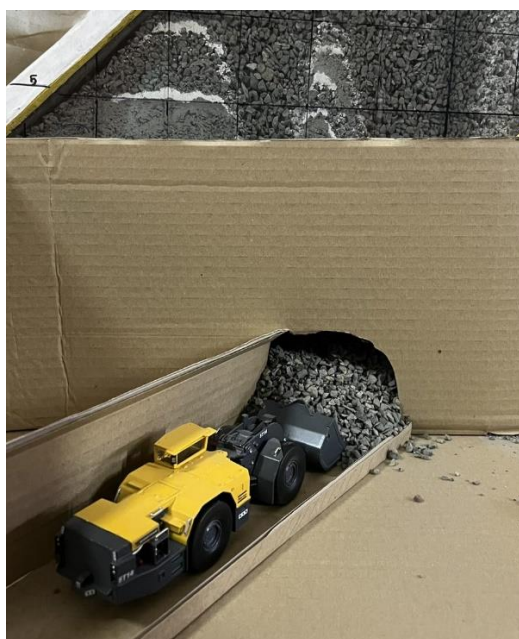
Рис. 2.3.1 – Загальний вигляд лабораторної моделі, під час випуску і навантаження відбитої рудної маси самохідною НДМ Scooptram ST14
