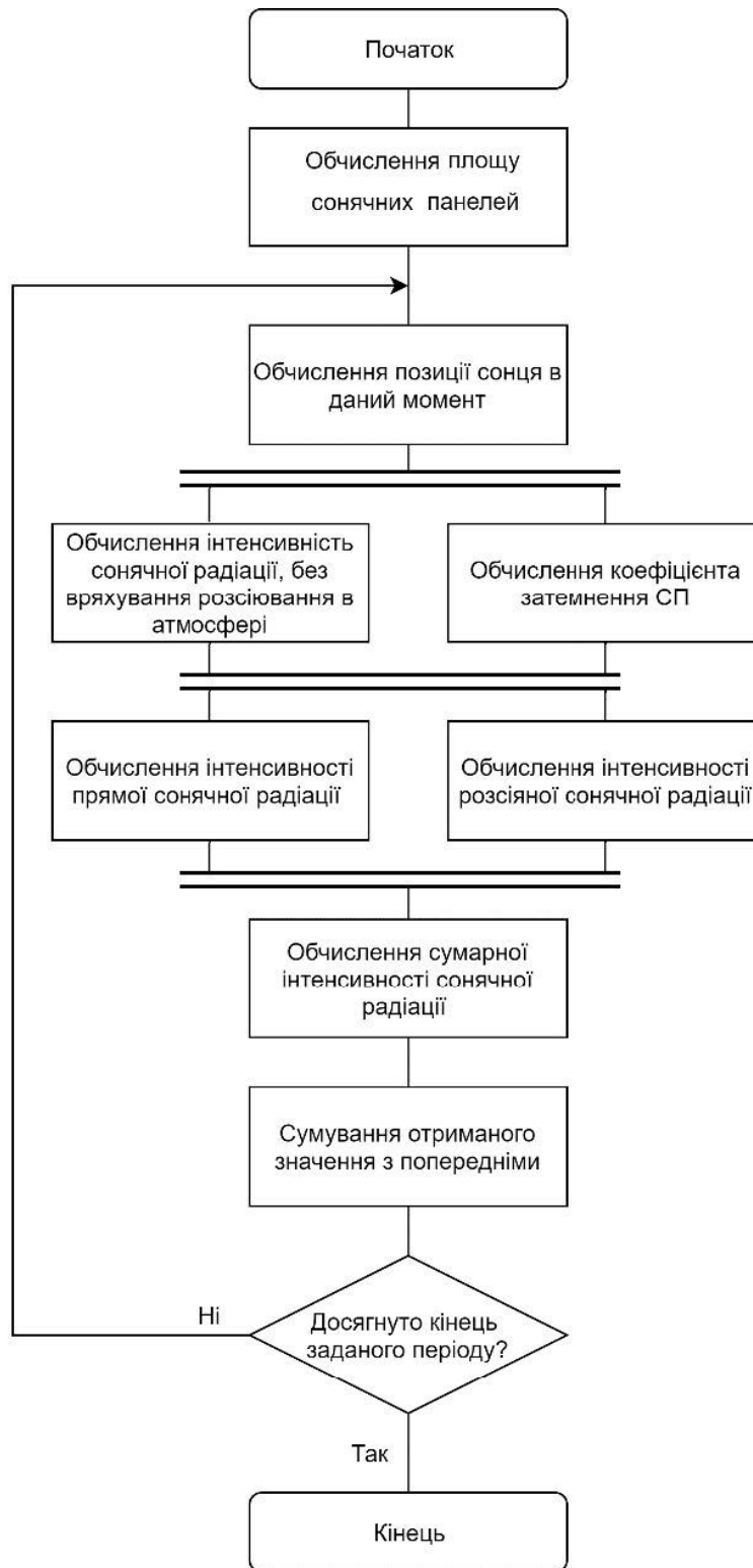
Рисунок 2.16 - Блок-схема для визначення сумарної інтенсивності сонячного випромінювання.
