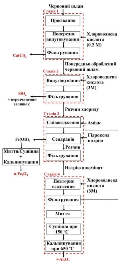
Рис. 2. Блок-схема вилучення глинозему та оксиду заліза з червоного шламу
