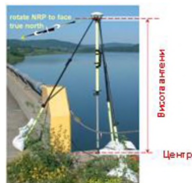
Рис. 4. Визначення висоти антени GPS-приймача
