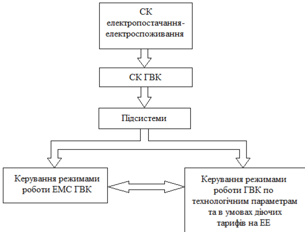
Рисунок 3.1 – Алгоритм функціональної структури системи керування головними водовідливними комплексами залізорудної шахти
