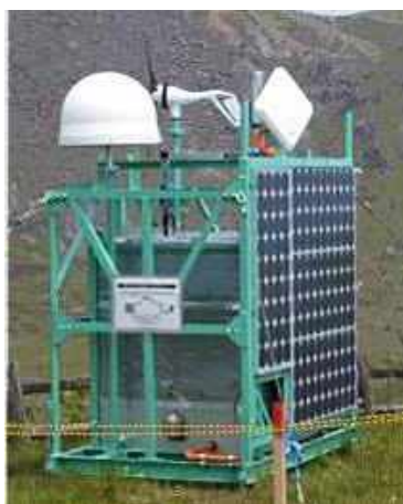
Рис. 9. REGMOS / (Станція дистанційної системи моніторингу GNSS)
