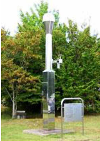
Рис. 7. Безперервно працююча опорна станція (CORS)
