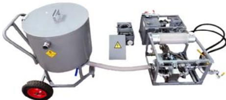
Доставка компонентов ЭВВ производится вагон-доставщиком ВДЭК-3 (ТУУ 29.2-23647075-017:2012), от которого до зарядной камеры прокладывается продуктопровод, по которому мембранным насосом перекачивается низковязкая эмульсия на расстояние до 100 м.
