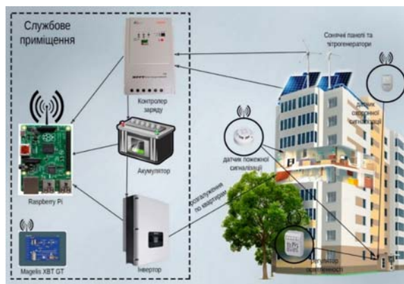
Рис. 1. Функціональна схема енергоефективної автоматизованої системи керування багатоквартирним будинком на базі технології IoT
