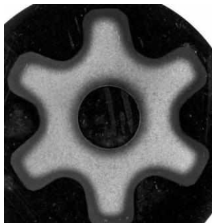
Рис. 2. Макроструктура металу деталі проби №1
