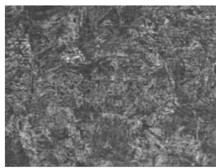
Рис. 5. Мікроструктура металу в перехідній зоні деталі проби №1
