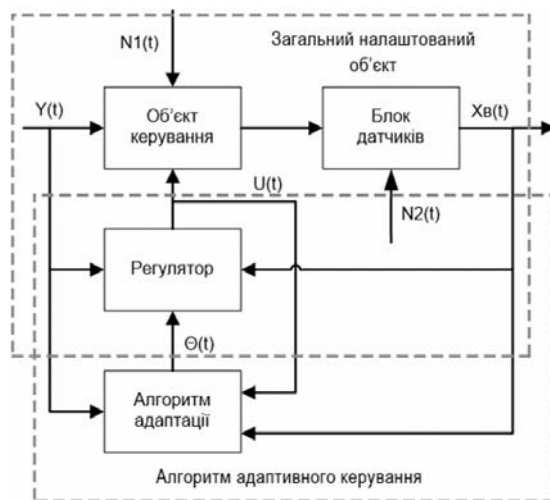
Рис. 2. Дворівнева структурна схема системи адаптивного керування
