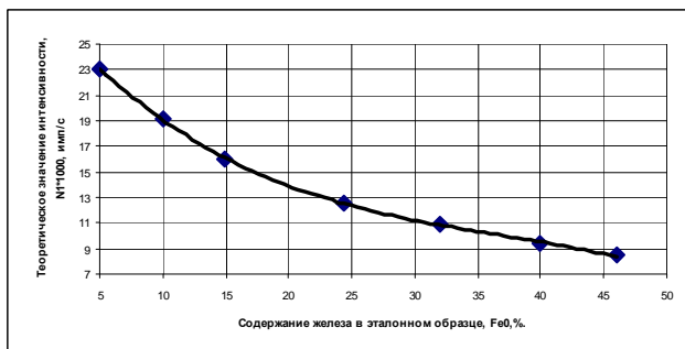
Рис. 1. Зависимость интенсивности теоретического значения гамма-излучения от содержания железа в эталонных образцах
