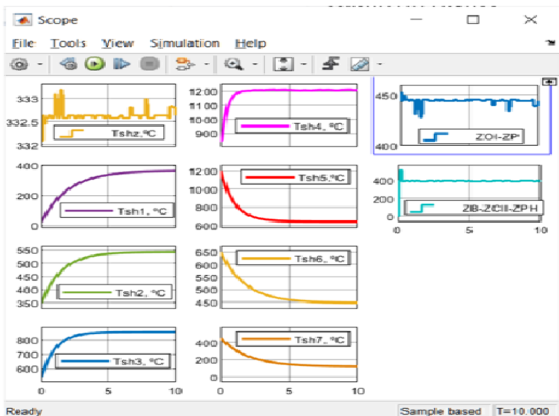
Рис. 3.3 Результати моделювання термічного процесу оброблення окатишів на конвеєрній машині з визначенням температури верхнього шару окатишів у кожній технологічній зоні
