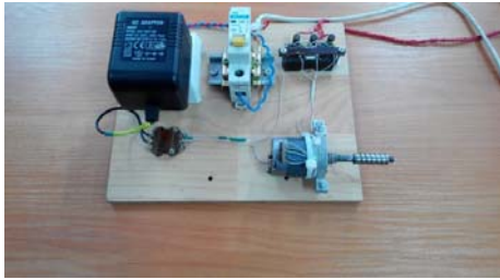
Рис. 3. Зовнішній вигляд стану для керування трифазним уніполярним кроковим двигуном
