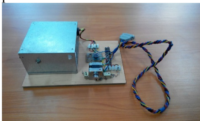
Рис. 10. Зовнішній вигляд стенду для керування кроковим двигуном з драйвером MP8825
