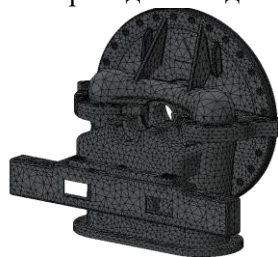
Рис. 4. КЕ сітка частини компресорної установки
