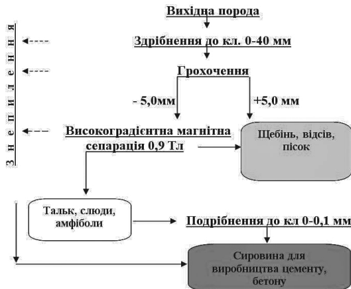
Рис. 3.4. Принципова технологічна схема переробки силікатних порід проходки підземних виробок Кривбасу (гранітів, аркоз, філітів, амфіболітів, силікатних і тальк-карбонатних сланців) у вихровому повітряно-мінеральному потоці
